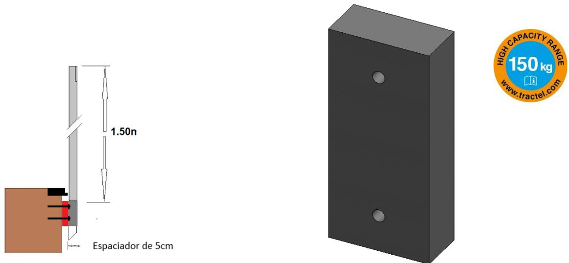
El espaciador se instala con 2 anclajes químicos de 12 mm, es el mismo anclaje químico que la base de los anclajes y no requiere herramientas específicas.
